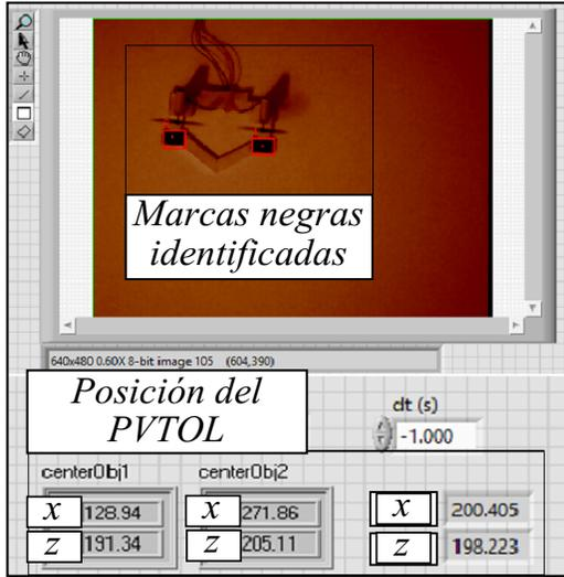
Fig. 5. Detección de marcas negras del PVTOL para calcular la posición y la orientación del vehículo.
