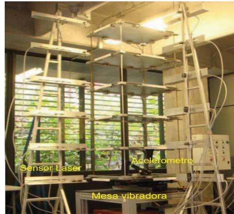
Figura 2. Edificio de cinco pisos escala reducida
