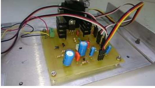
Figura 5. Vista del circuito impreso del amplificador de potencia con sus componentes montados.
