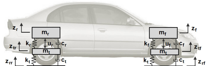
Fig. 3. Automóvil visto como dos subsistemas masas-resortes-amortiguadores desacoplados.
