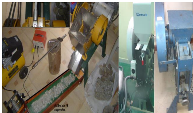
Fig. 1.- El prototipo construido (izquierda), de acuerdo a la (derecha) trituradora marca Retsch de fabricación alemana
