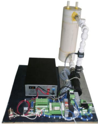
Figura 6. Equipo empleado para el control de caudal.
