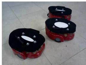
Figura 2: Robot móviles del tipo AmigoBot
