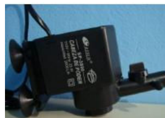
Figura 6. Bomba de circulación (Bomba para pecera)
