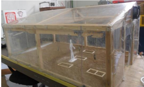
Figura 7. Maqueta a escala del invernadero
