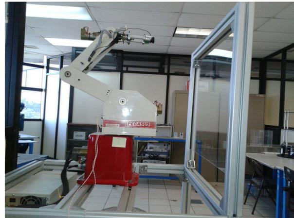
Figura 2. Plataforma experimental desarrollada con el Robot pegasus.
