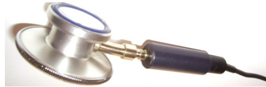
Figura 2. Sensor acústico para el monitoreo de los sonidos cardiacos.
