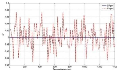
Figura 13: Resposta da malha do processo mantendo a referência do pH constante.
