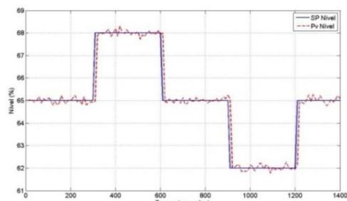
Figura 12: Resposta da malha do processo inserindo uma variação na referência do nível.
