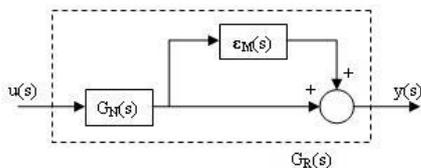
Figura 4: Diagrama de bloco da planta real incluindo o erro multiplicativo.
