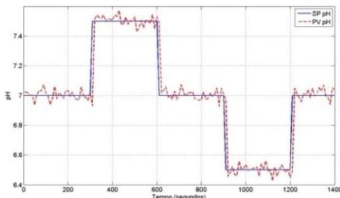
Figura 14: Resposta da malha do processo inserindo uma variação na referência do pH.
