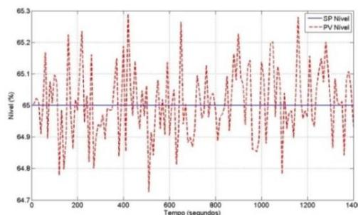
Figura 15: Resposta da malha do processo mantendo a referência do nível constante.
