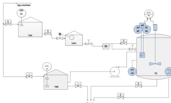
Figura 1: P&ID da planta piloto de neutralização de pH.
