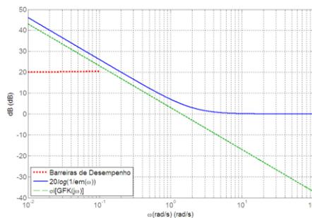
Figura 9: Valores singulares de  $GKF(j\omega)$ .
