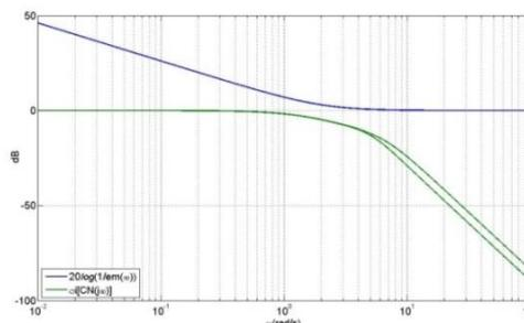
Figura 11: Verificação da Condição de Robustez da Estabilidade.
