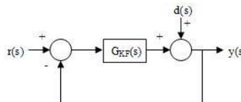
Figura 7: Diagrama de bloco da Malha Objetivo.
