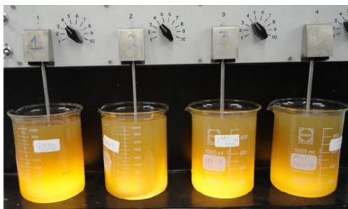
Fig. 1. Equipo experimental (jar test apparatus) para llevar a cabo el tratamiento del agua de la presa San José.
