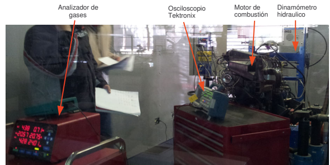
Fig. 1. Motor de combustión interna a gasolina acoplado al dinamómetro SuperFlow SF-902.
