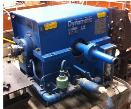
Figura 1. Dinamómetro Dynamatic 8060.
