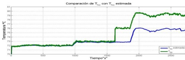
Fig. 5. Comparación entre  $T_{ho}$  y  $\hat{T}_{ho}$  estimada, con una falla en  $T_{ho}$  de  $3^{\circ}\text{C}$  al tiempo  $kd=1625$ .
