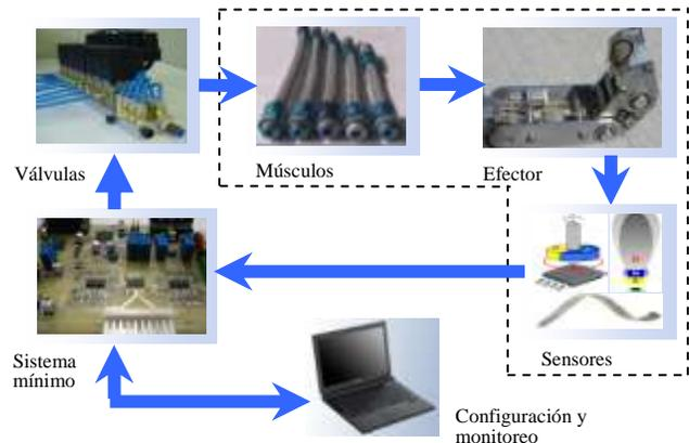
Figura 10. Diagrama a bloques del sistema de dedo neumático.
