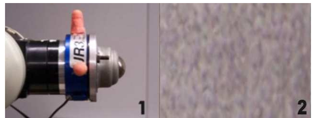
Figura 1. Bala giratoria(1), superficie porosa(2)
