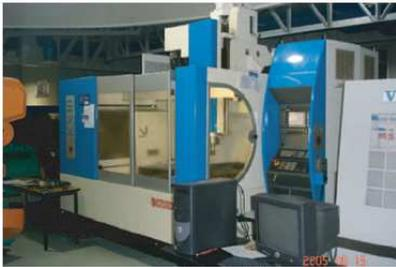
Figura 6. Centro de maquinado vertical industrial CNC Huron KX-10
