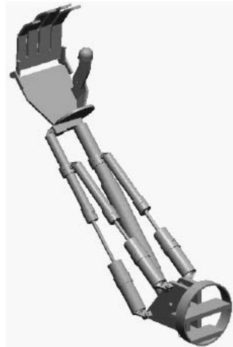
Fig. 1. Prótesis de 3 grados de libertad en el codo, con actuadores en paralelo
